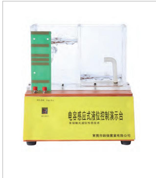
電容式感應液位傳感器是本公司最新研發的液位傳感器系列之一，廣泛應用於各種需要液位元件檢測的電器設備中。其獨有的無接觸式感應方法，徹底解決了食用級產品使用傳統技術所帶來的液位不準確、壽命短、二次污染、難清洗、難安裝的問題。
