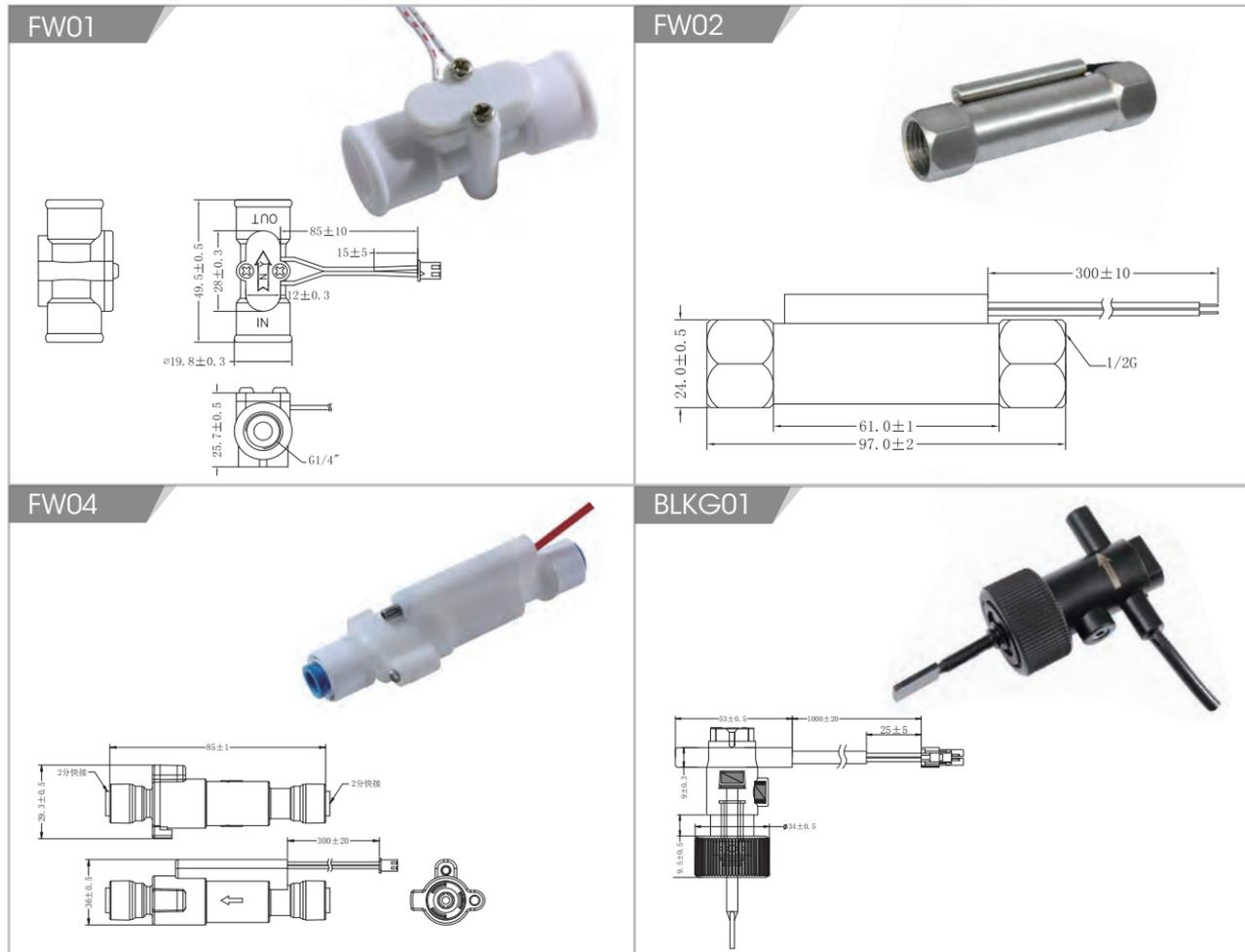
流量開關是用于電熱水器、太陽能熱水器、空調器以及其他水系統的水循環控制、進出水控制、水加熱控制、水泵開關控制、電磁閥通斷控制或出水斷電、出水通電控制等過程，當達到一定流量後將水流轉換為開關式電信號的傳感器件。流量開關由磁芯、復位彈簧、鍛銅或聚碳外殼和傳感器組成。
